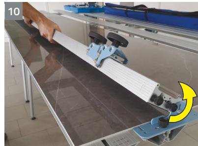
**Ruotare la guida e inserire la lastra in posizione di taglio (A).**
